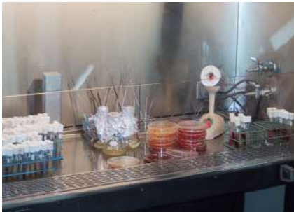
Cámara de flujo laminar
